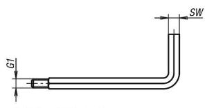
特殊的六角扳手,带 螺纹销。拧入螺纹 G1, 对其定位和松开。
