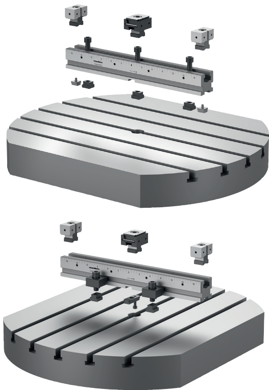
在 T 型槽机床工作台的纵向和横向上可安装多重夹持系统。 用型槽螺母找齐。用固定螺栓或夹紧钳固定。
