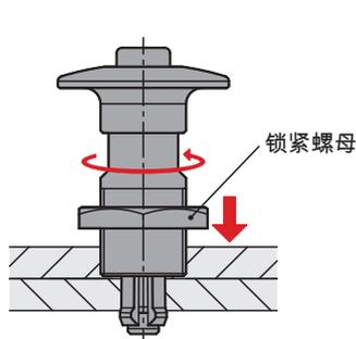
向另一个方向拧动锁定销，直至两块板件合在一起，随后用拧紧螺母固定。
