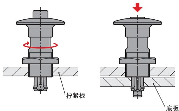
将锁定销拧入安装板中，直到另一侧可以看到螺纹为止。
